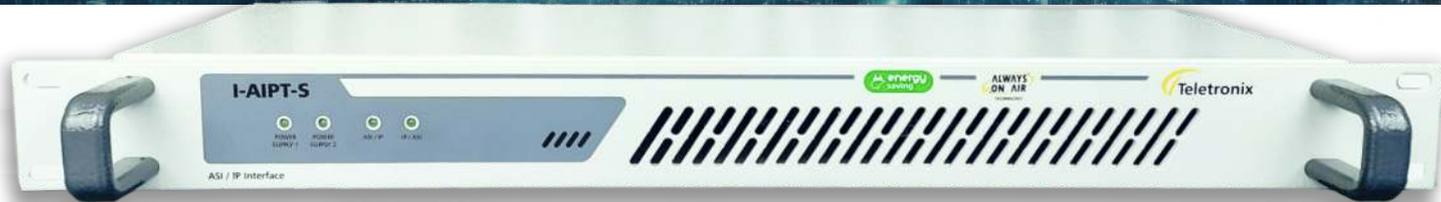
Uma maneira fácil de adicionar uma entrada ou saída IP para seu produto de processamento de TS. Tunnelling de sinais ASI em LAN, WAN ou Internet.
